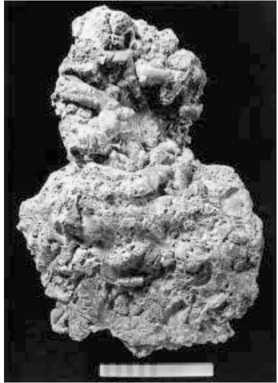
Fig. 12. Complete 'cake' of tap slag (scale = 0.2 mm).
