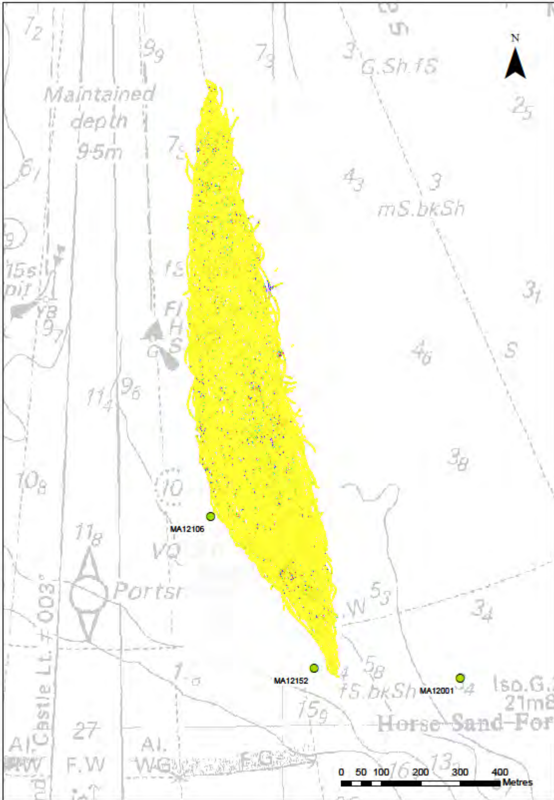
Pre dredge magnetic (Subtem and TSS) survey
